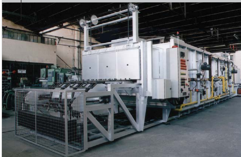
Instalación continua para distensionado de garrafas Instalação continua para distensionado de garrafas
