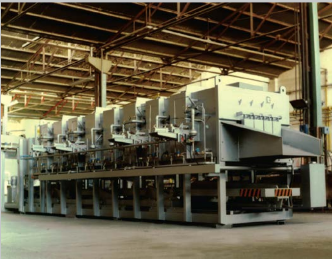
Horno de calentamiento para extrusión de billets de aluminio. Avance por paso peregrino Forno de aquecimento para extrusão de tarugos de alumínio. Avance por passo peregrino
